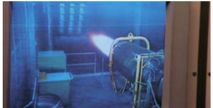
In Vertretung der Armasuisse übergibt RUAG Centerleiter Daniel Brunner (links) die Triebwerkakten und ein symbolisches Triebwerk dem Vereinspräsidenten Ferdinand Meyer. Auf dem Bildschirm des Triebwerkprüfstandes ist der Nachbrenner gut zu erkennen.
